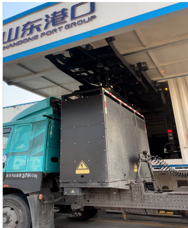
图 6-10 顶吊式换电站换电实拍图——前湾港四期码头 001 号站
